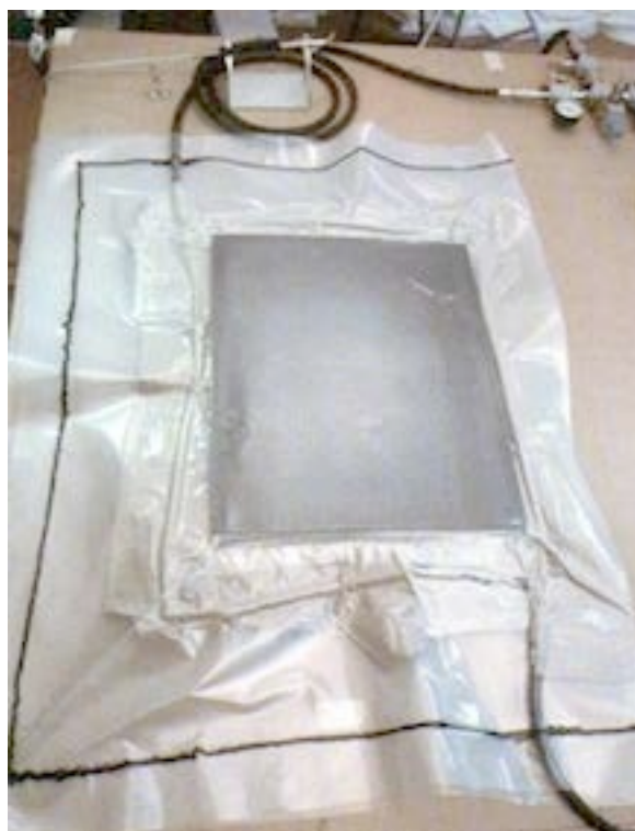
Tavola 26 – Idem, intero, durante la fase di consolidamento in sottovuoto. Per aumentare la pressione meccanica sulla superficie pittorica e nello stesso tempo per evitare collassamenti localizzati della preparazione, è stato inserito, dentro la busta e appoggiato sulla tavola, un piano semirigido di gomma
