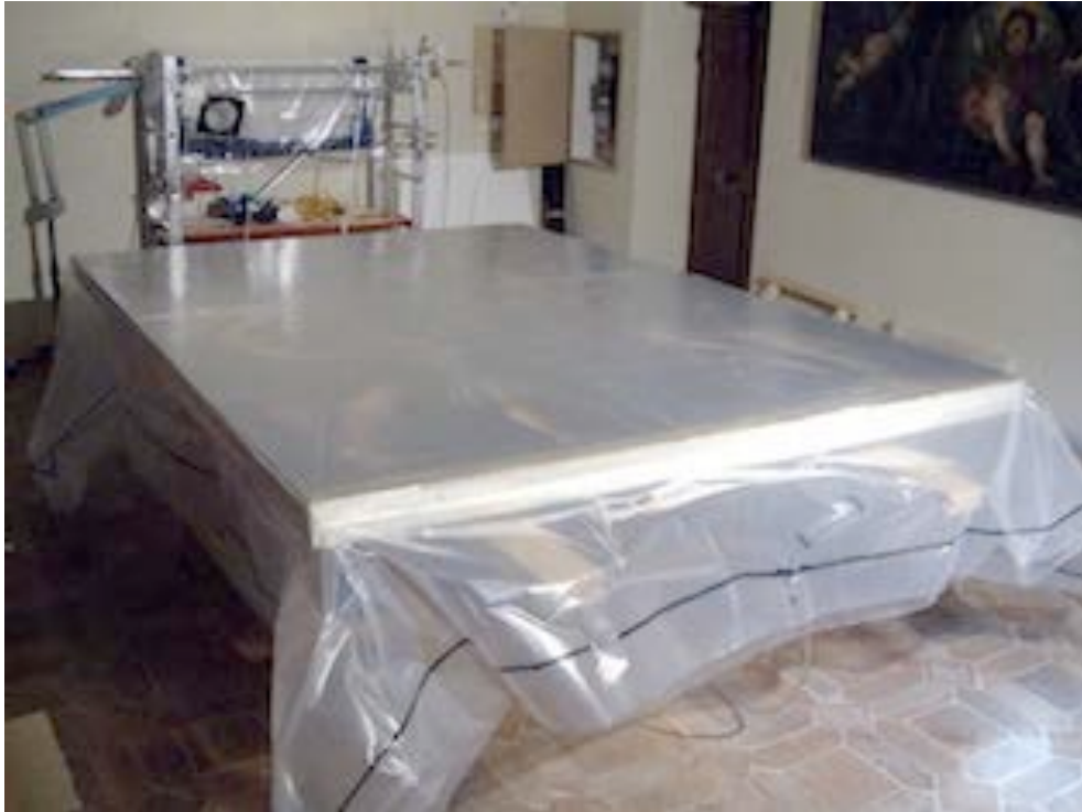
Tavola 37. La tavola inserita dentro la busta e sigillata con plastilina è stata sottoposta lentamente e gradualmente alla pressione del sottovuoto
