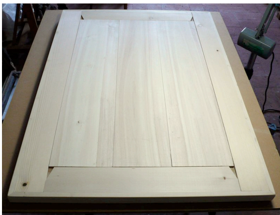
Figura 2. Recto del TET, il piano a contatto della tela
