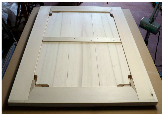
Figura 3. Verso del TET, con il sistema di espansione a biette. La traversina centrale è provvisoria e sarà rimossa alla fine del montaggio
