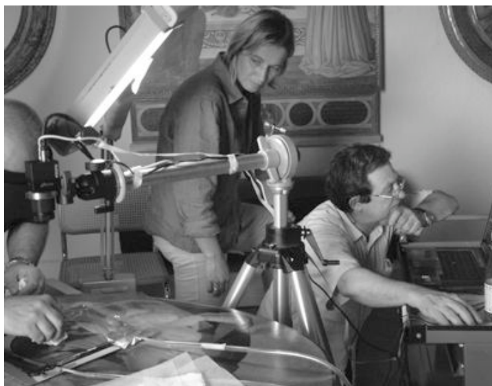
Figura 12. Consolidamento del colore con il sottovuoto localizzato sotto il controllo della telecamera termografica.
